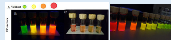
Obr. 3: A) Modely velikosti CdTe QDs, B) fotografie CdTe QDs pod UV svěletem, C) fotografie CdTe QDs bez UV záření
