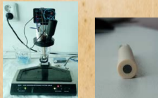
Obr. 1: Použitý polarografický analyzátor a detail BDDE
